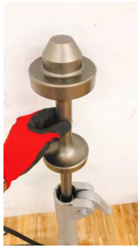
杭打撃治具の挿入
